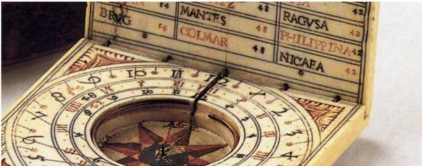
Abb. 7: Detail einer Klappsonnenuhr wohl von Joseph Tucher, Nürnberg, mit Stift für die Markierung der magnetischen Missweisung.
